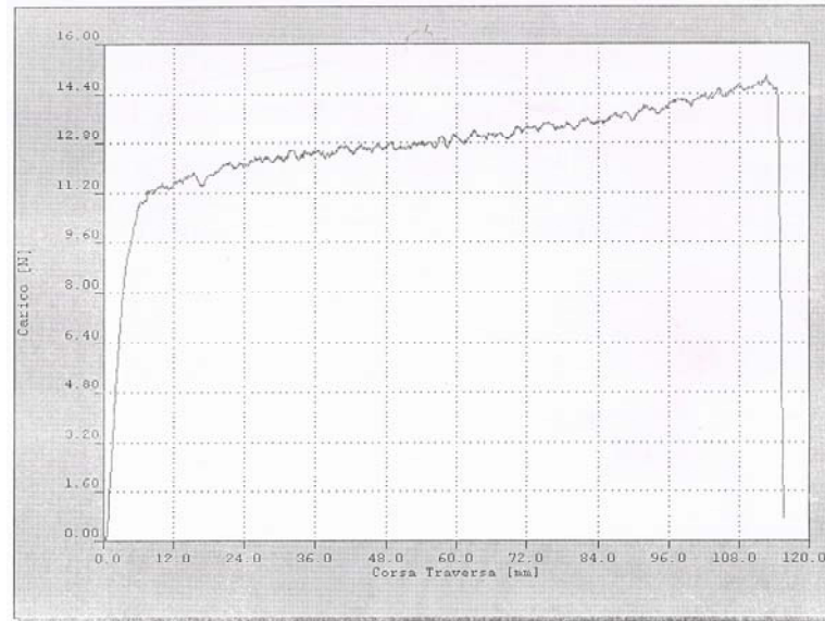
Figura 2: Diagramma carico/deformazione a trazione di un campione di film prodotto da granulo riciclato ricavato da plastiche agricole dismesse.
